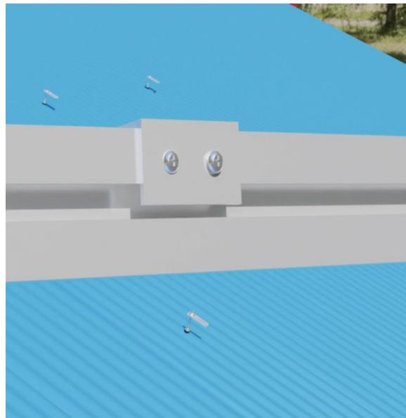
7. Führen Sie nun die Hammerschraube in das Aluminiumprofil ein und befestigen Sie das Aluminiumprofil mit der Adapterplatte wie gezeigt:
